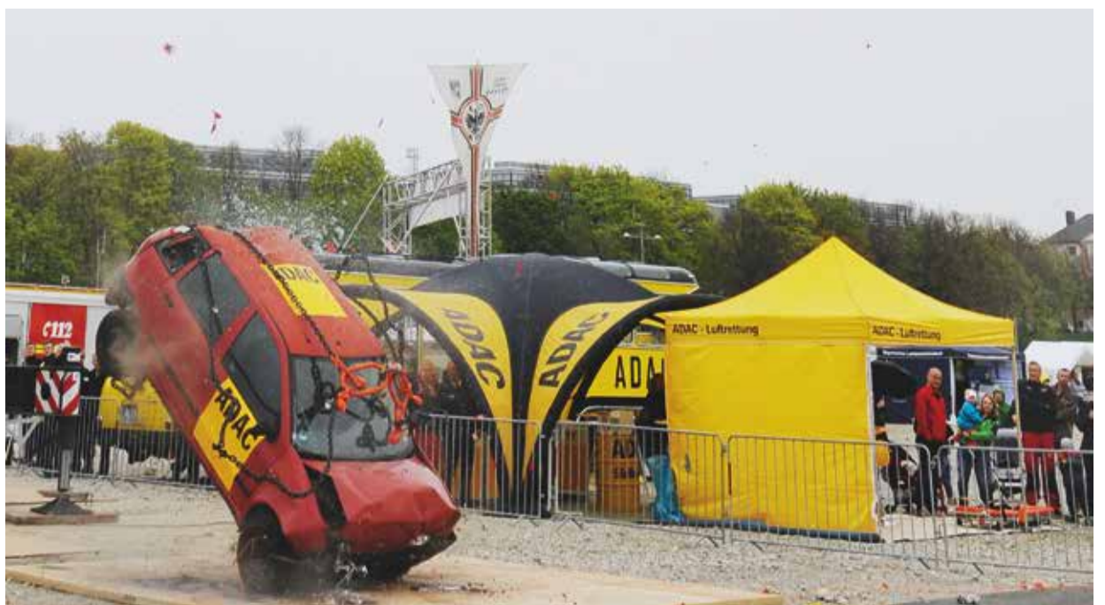
Spektakulär: Der ADAC Autoabwurf simulierte einen Frontalaufprall mit Tempo 50.
